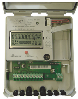
Vista del interior, tipo Pt 500, alimentado por batería
